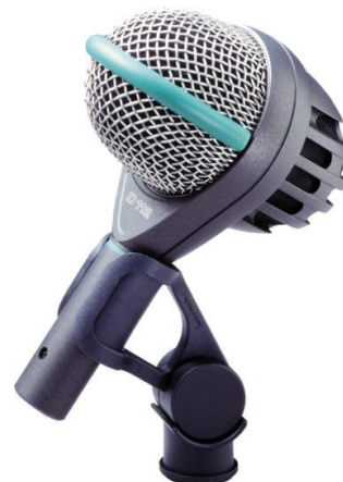
Ilustrační obrázek: jeden z nejpoužívanějších dynamických mikrofonů na snímání basového bubnu („kopáku“) – AKG D112. Díky větší membráně mají tyto mikrofony lepší citlivost na nízké frekvence. Mikrofon lze též s úspěchem použít i např. na snímání baskytarových komb.
