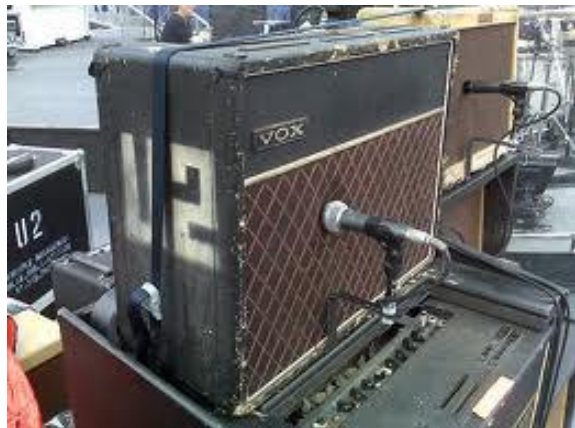
Příklad metody „Close miking“ při snímání kytarového aparátu
