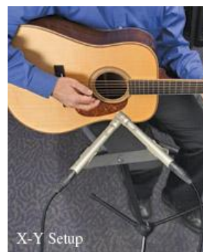
Obrázek: ukázka snímání akustické kytary metodou X/Y
